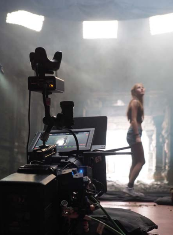
Jungdarstellerin Nuria vor Kamerasystem mit aufgesetztem Tracker zur Übertragung der Kamerabewegungen an die Unreal Engine © LUMALENSCAPE
